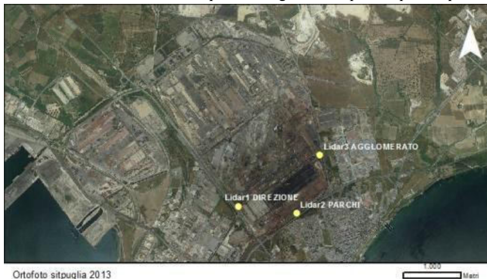
Fig. 1: Posizionamento dei tre sistemi LIDAR posti lungo il perimetro dello stabilimento industriale Acciaierie d'Italia.
