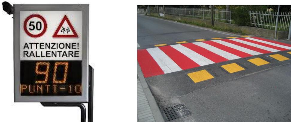
Figura 11 - Sistemi di riduzione della velocità
