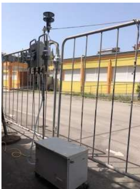
Figura 1: In alto immagine satellitare con evidenza degli intervalli di campionamento: sottovento in rosso (55°-254°) e sopravvento in verde (255°-54°). In basso: foto del campionatore Wind Select.
