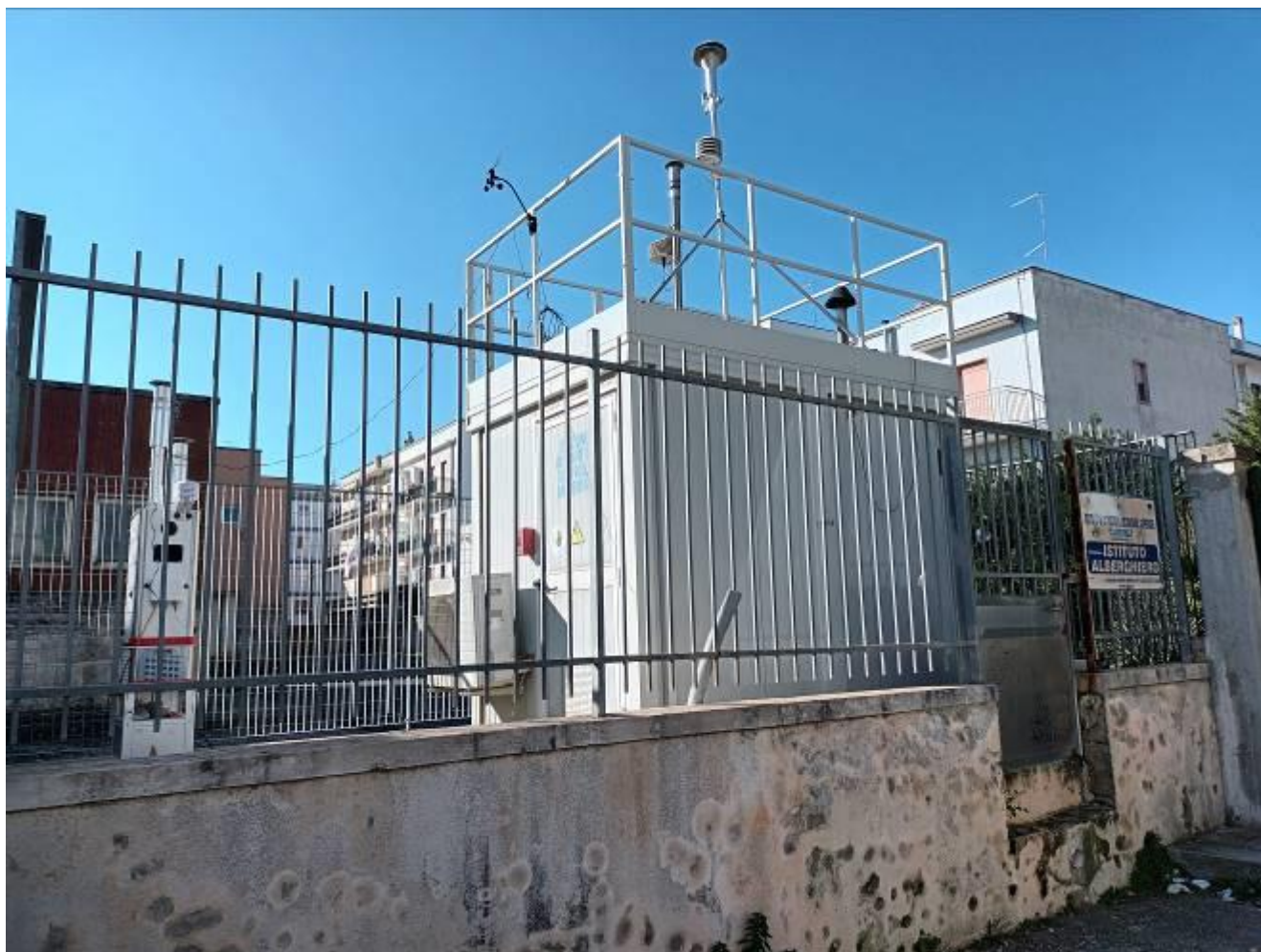
Figura 2: Foto del campionatore Dadolab Gemini installato in prossimità della centralina RRQA di Ceglie Messapica.
