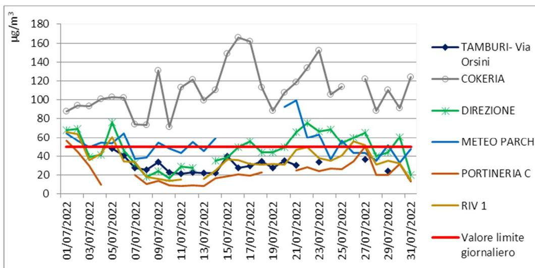
**Figura 10** Livelli di concentrazione Luglio 2022 di PM<sub>10</sub> (SWAM) in µg/m<sup>3</sup>
