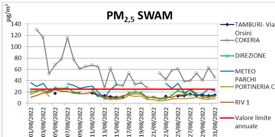
**Figura 16** Livelli di concentrazione di PM<sub>2,5</sub> in µg/m<sup>3</sup> (rete AdI con Cokeria)
