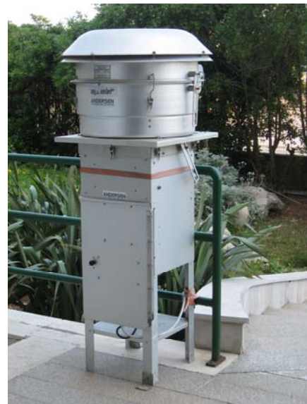
Foto 4: Campionatore ad alto volume nel sito di monitoraggio ARPA a Corso Trieste, Bari - sede ARPA Puglia
