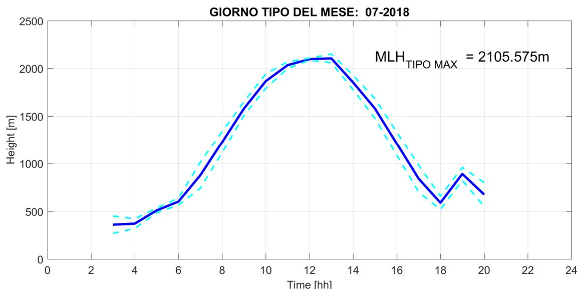
**Fig. 2: Giorno tipo del parametro Mixing Layer Height nel mese di LUGLIO 2018, rappresentato mediante media oraria (linea blu continua), e quartili corrispondenti ad una deviazione standard (linee celesti tratteggiate).**
