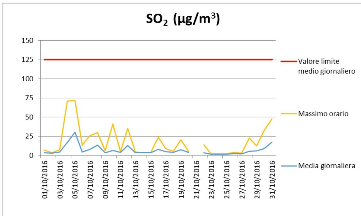
**Fig.16 - Livelli di concentrazione di SO<sub>2</sub>**
