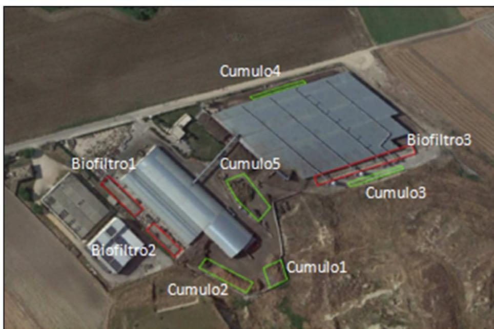
Fig. 1: Localizzazione delle sorgenti odorogene all'interno dell'impianto
