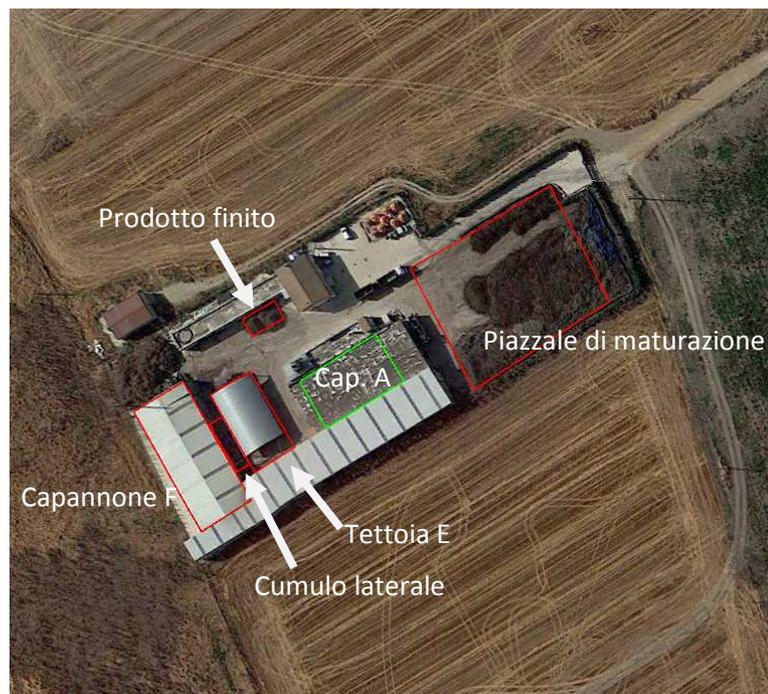
Fig. 1: Localizzazione delle sorgenti odorigene all'interno dell'impianto
