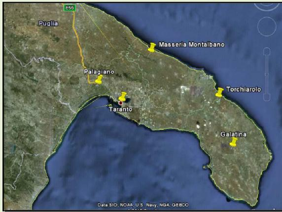
L'attività in campo è consistita in una campagna multicentrica in 5 siti di misura (mostrati di fianco), di cui 2 nell'area di Taranto e 3 nell'area salentina (uno di "fondo" per ogni area), con campionamenti di PM10 mediante campionatori di tipo bicanale, su supporti adatti per le successive analisi (fibra di quarzo e policarbonato), e campionamento separato di alcuni filtri in modo da permettere un'analisi di tipo "morfologico" delle particelle mediante SEM/EDS.
