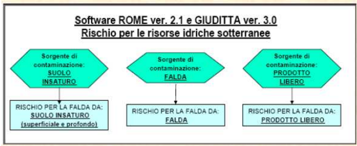
Figura 9: Rischio per le risorse idriche sotterranee (da Criteri metodologici per l'applicazione dell'analisi assoluta di rischio ai siti contaminati, Revisione 2 – marzo 2008 APAT).
